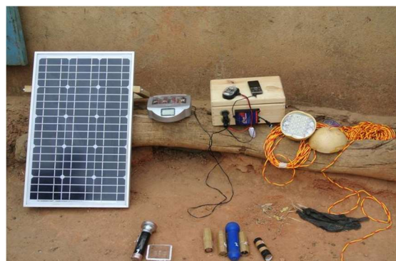
Bestandteile eines Solar-Home-Systems
