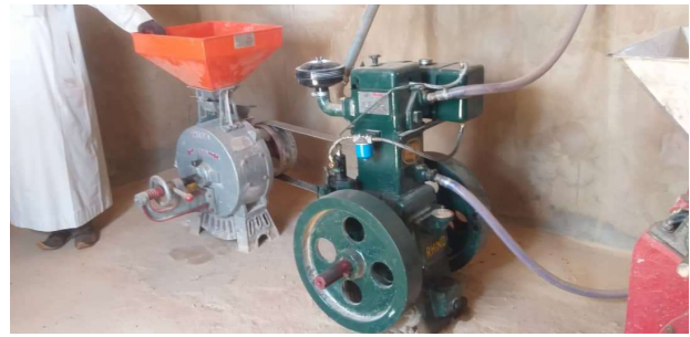
Aufbau einer robusten Getreidemühle mit Motor und Mahlwerk
