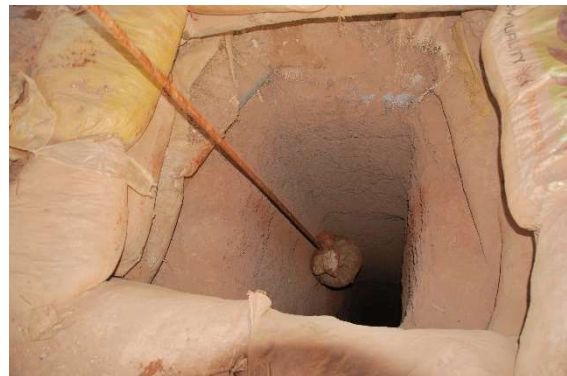
Erdreich mit Goldstaub wird aus 20 m Tiefe hochgezogen
